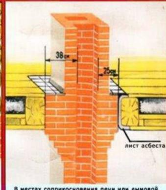
В нестах соприкосновения печи или дыновой трубы со сгораеными конструкциями дона должны быть устроены кирпичные разделки толщиной не менее 38 см; при условии защиты деревянных конструкций асбеста или войлоком, сноченным в глиняном растворе. - 25 см.
