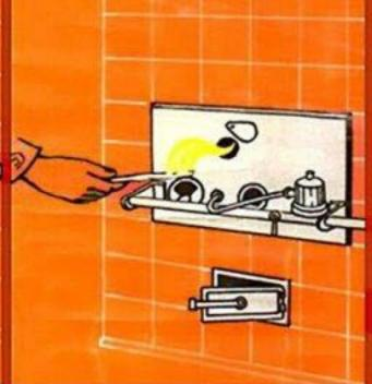
Перед растопкой печей, оборудованных под газовое отопление, проветрите топливник, затем убедитесь, есть ли тяга в дымоходе.
